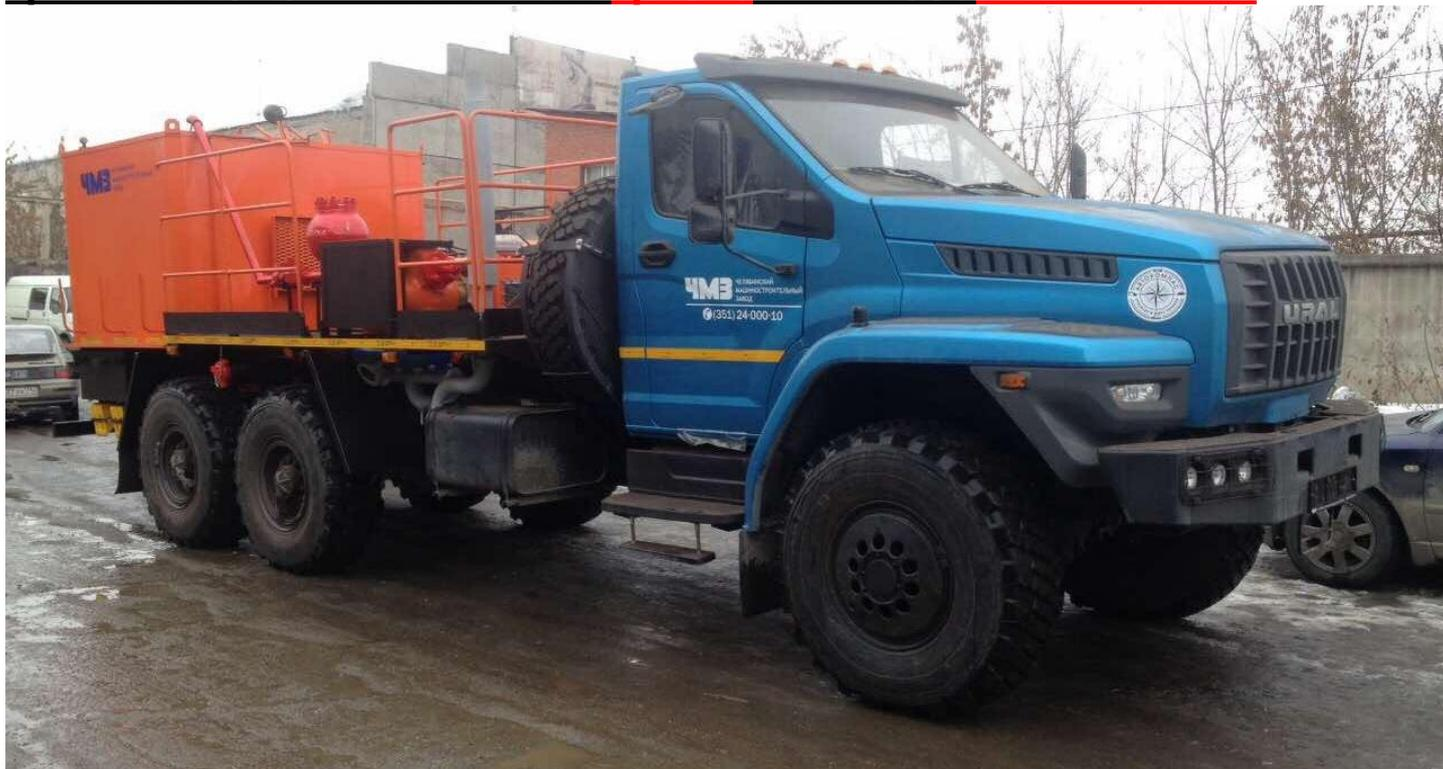
Установка предназначена для нагнетания тампонажного раствора и продавочной жидкости в скважину, а также для подачи затворяющей жидкости в смесительное устройство при приготовлении раствора. Кроме того, установка может использоваться для выполнения других работ: промывки и продавки песчаных пробок, опрессовки труб, колонны, манифольдов, гидравлического перемешивания раствора. Установка может использоваться и в других отраслях согласно техническим характеристикам установки.
